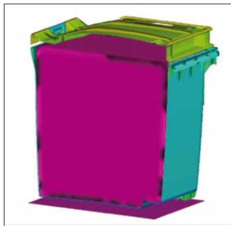
Finite Elemente Stoßsimulation: Simulation des Falltests für einen Müllgroßbehälter
